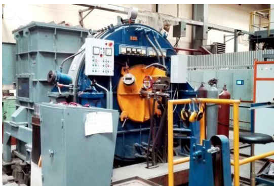
7 – сурет – УЦР – 6К ортадан тепкіш шашыратудың плазмалық қондырғысы
